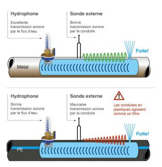
A la différence du système d'écoute par microphone, l'hydrophone mesure le flux de l'eau, à l'identique d'un sonar de sous-marin.
